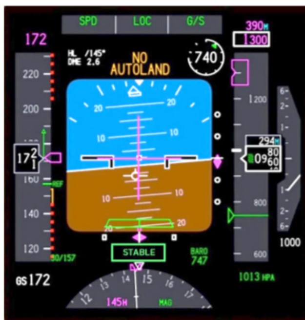
Рисунок 1. Вывод информации на PFD Boeing 737NG
